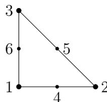
Achten Sie auf eine konsistente Nummerierung bei der Aufstellung der Basisfunktionen! Sei  $E$  die Elementliste, in der in jeder Zeile ein  $\mathcal{P}_2$ -Dreieck beschrieben ist. Mit obiger Sortierung lassen sich die Knoten der  $\mathcal{P}_1$ -Diskretisierung einfach über die ersten drei Spalten von  $E$  bestimmen.
